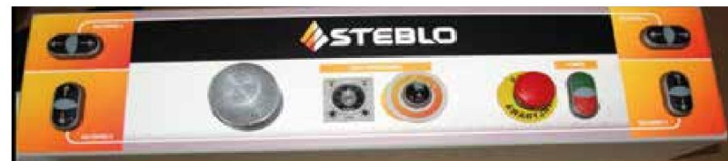
Na każdym z pulpitych znajduje się przycisk grzybkowy „Awaryjny Stop” odcinający dopływ zasilania, a tym samym powodujący całkowite zatrzymanie wszystkich układów.
