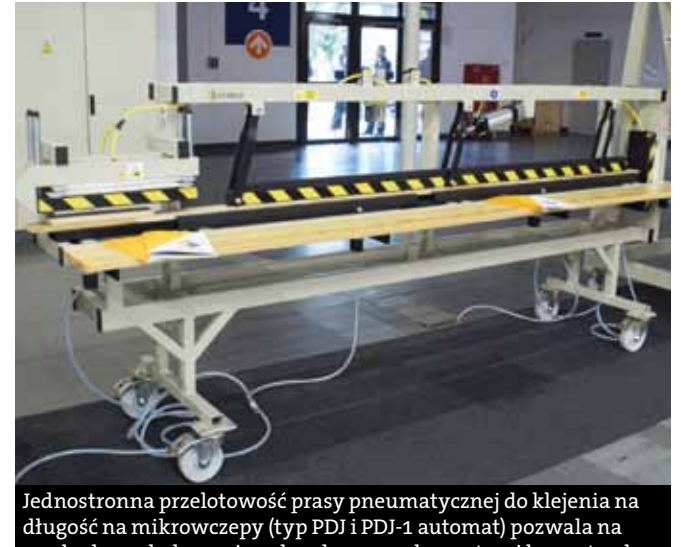
Główne cechy prasy pneumatycznej montażowej typ PMJ to: możliwość montażu wszelkich konstrukcji ramowych, regulowana siła nacisku, przesuwne siłowniki, szybki i wygodny montaż klejonych elementów oraz regulacja ustawienia kąta.
