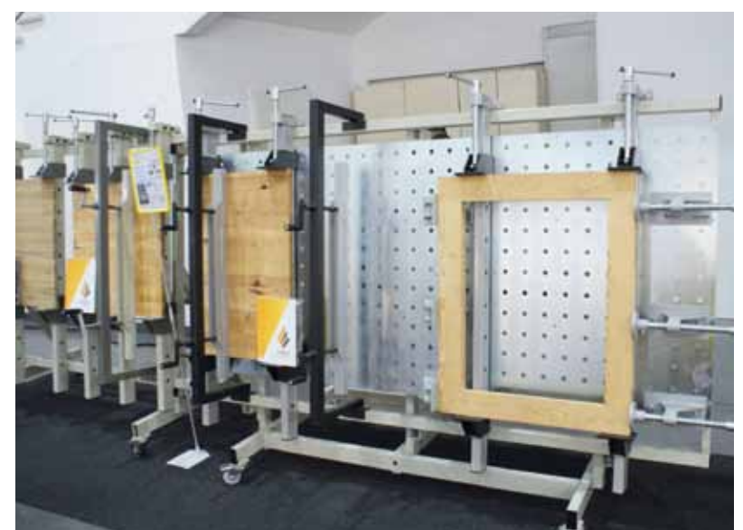
Ściski wzmocnione przesuwne na stojaku z płytą otworową to doskonałe urządzenie do małych zakładów stolarskich. Umożliwiają one klejenie drewna w płyty, montaż okien, drzwi oraz elementów przestrzennych.
