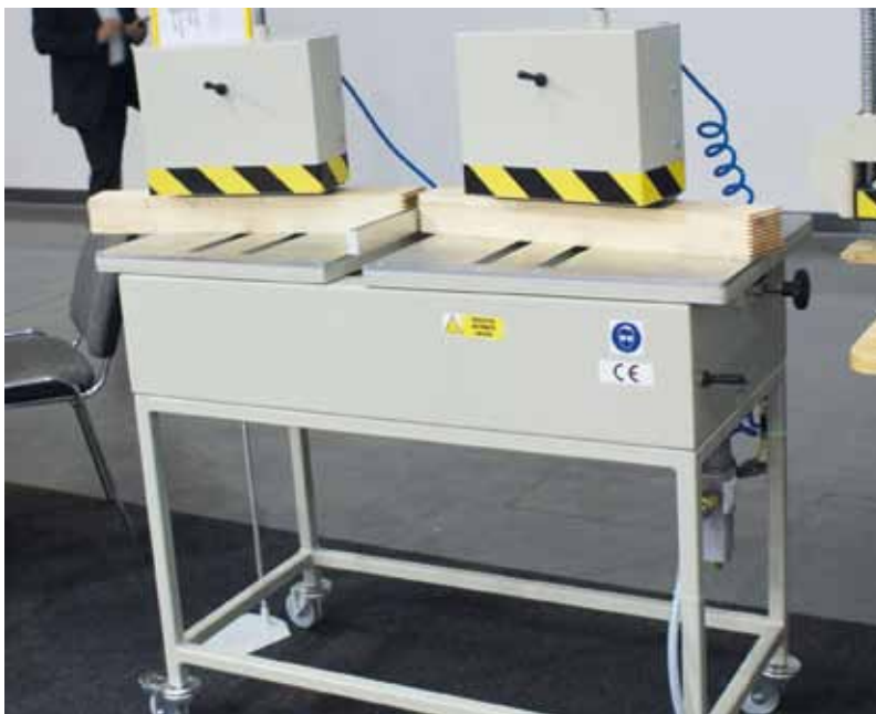
Główną zaletą prasy pneumatycznej do klejenia drewna na mikrowczepy jest możliwość łączenia pod dowolnym kątem.
