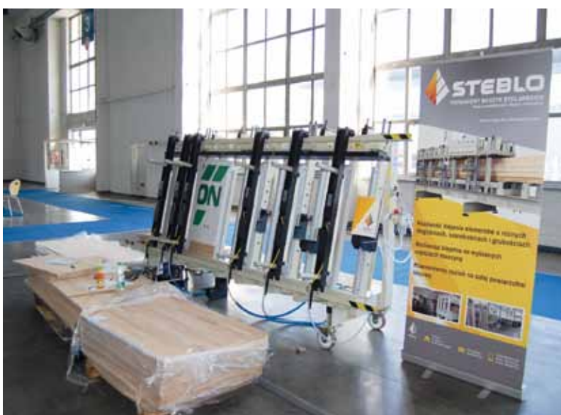
Podczas tegorocznej Fabryki Mebli na Żywo firma STEBLO współpracowała przy projekcie „DREMA DZIECIOM”, udostępniając prasę pneumatyczną trapezową jednostronną pozwalającą na klejenie drewna w płyty i na grubość.
