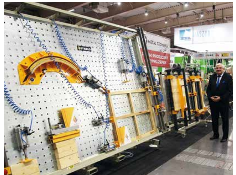
W kategorii pras montażowych STEBLO zaoferowało m.in. ramę typ PMO wyposażoną w płytę otworową oraz belki wyrównujące do kąta prostego. Fot. STEBLO
