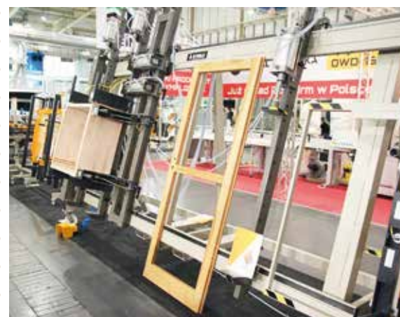
Prasa pneumatyczna montażowa typ PMJ z siłownikami pionowymi o regulowanej wysokości. Fot. STEBLO
